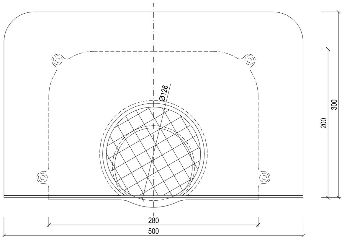
KF 6541-2 Flavent® Attika-/Balkonablauf DN 100 mit Bitumen-Manschette
