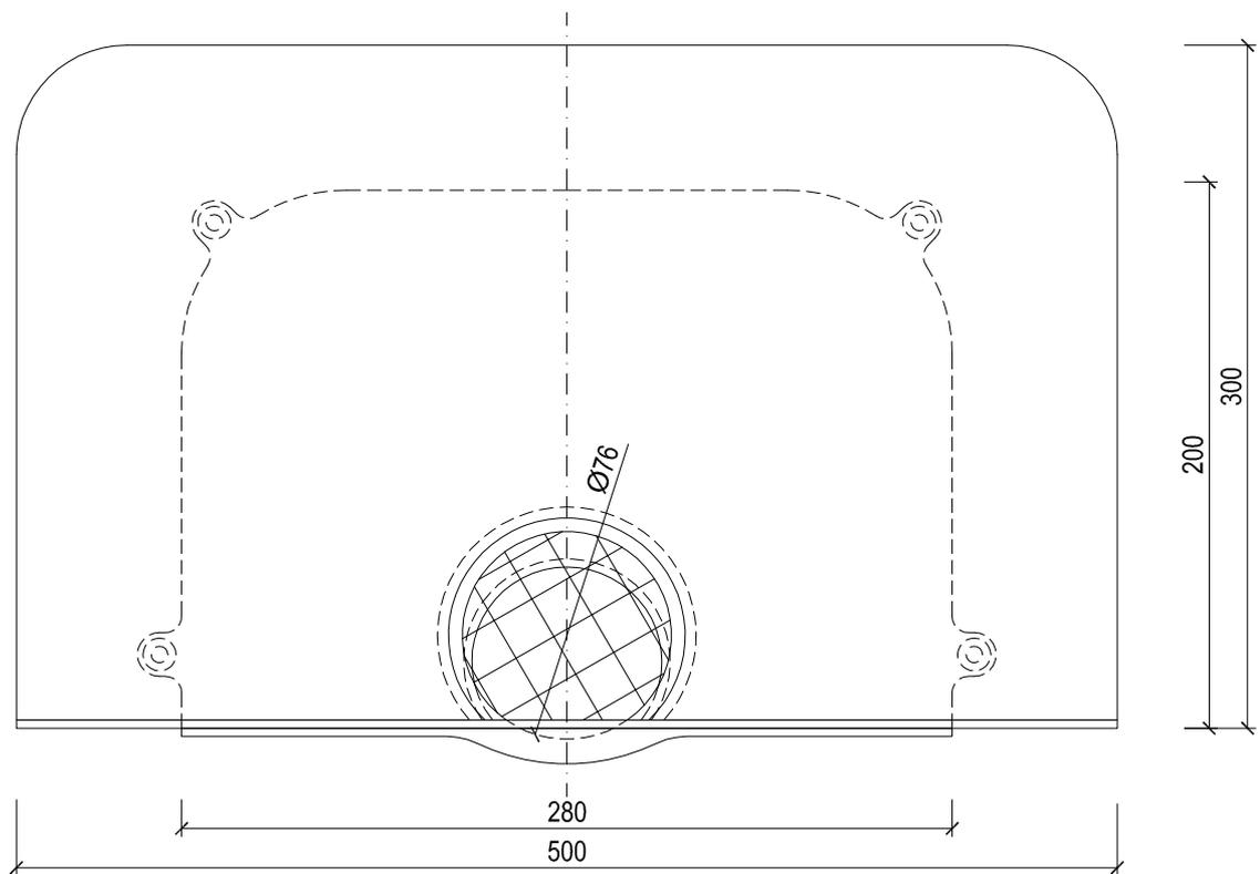
KF 6531-2 Flavent® Attika-/Balkonablauf DN 70 mit Bitumen-Manschette
